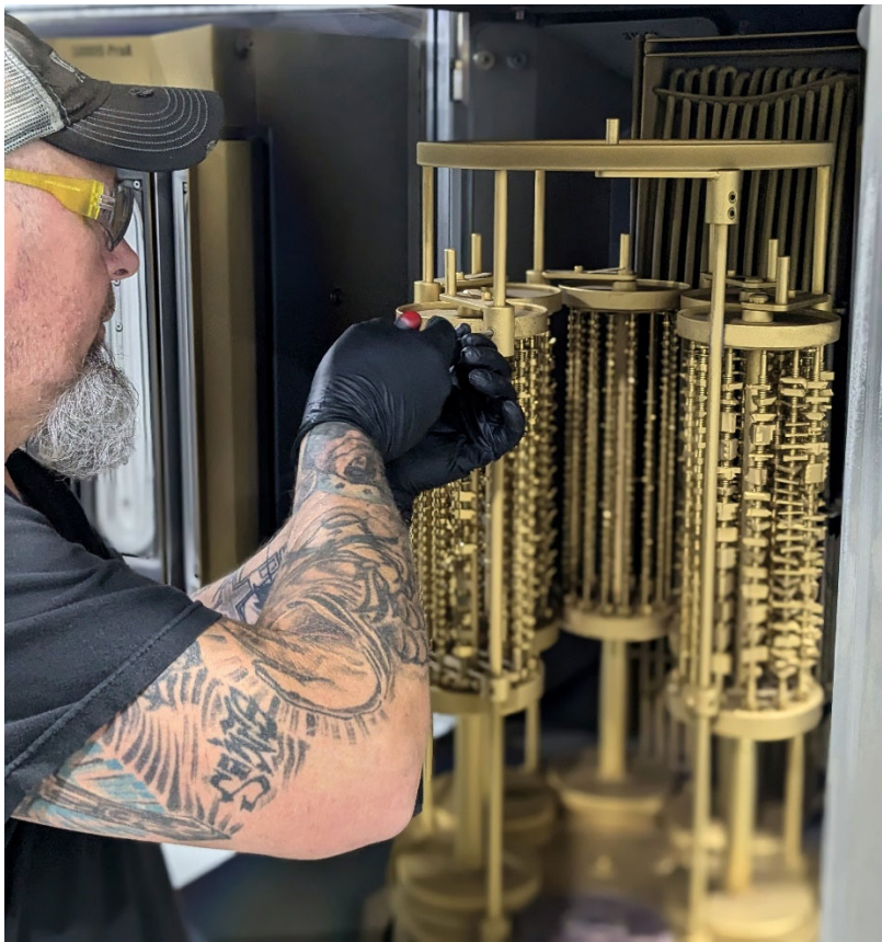
Die CemeCon Beschichtungslinie mit zwei CC800® HiPIMS konnte nahtlos in den Produktionsprozess bei HORN USA integriert werden.
