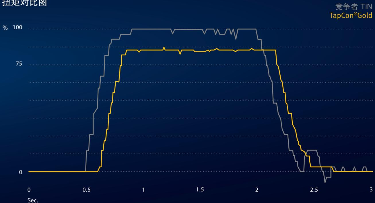
稳定的低扭矩对于精确和有效的螺纹生产非常重要。最新开发的HiPIMS涂层材料TapCon® Gold专门对这些需求量身定制，是HSS丝锥和螺纹成型刀具的理想涂层。
