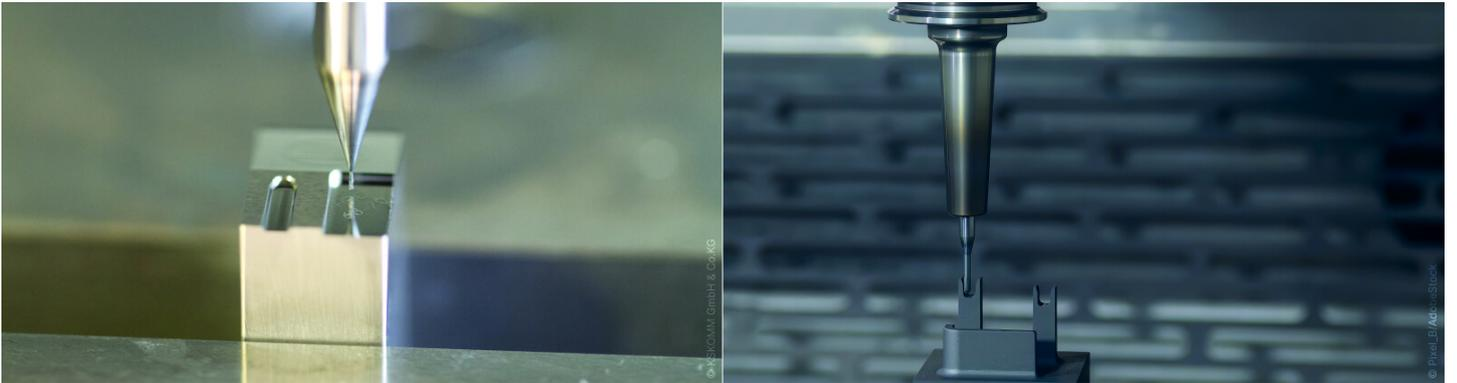
超薄型のHiPIMSコーティングは、複雑な工具形状を一对一で再現します。CemeConの技術製品マネージャー、Christoph Schiffrersはこう述べます。「マイクロツールのフィリグリー形状に接着性とプロセス信頼性が高い方法でコーティングを施すには、適合した残留応力が必要です。これが、微細な刃先形状を均一にコーティングする唯一の方法です。当社のHiPIMS技術によって、残留応力を制御し大幅に低減することができるので、マイクロツールの鋭利な刃先に最適なのです。」
