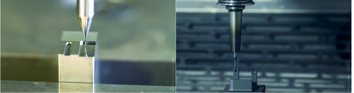
超薄HiPIMS涂层能够精准一对一再现复杂刀具的几何形状。CemeCon技术产品经理Christoph Schiffers：“如果您想以可靠的工艺在微型刀具的细微形态上涂层，您首先要做的就是降低残余应力。这是均匀涂覆精密几何形状切削刃的唯一方法。通过我们的HiPIMS技术，可以控制并显著降低残余应力，非常适合在微型刀具的锋利切削刃上进行涂层作业。”
